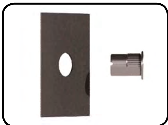
PERFORAR LA CHAPA
